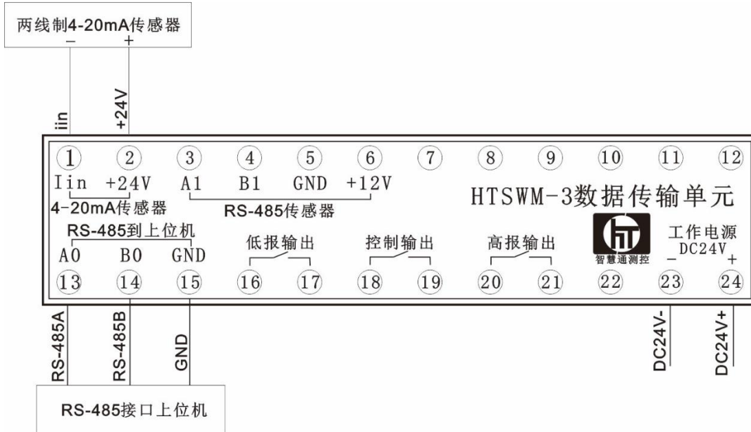
两线制4-20mA接口传感器接线示意图
