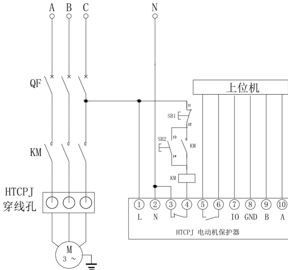
此图是三相电机建议接线图，若用于单相电机过流保护，可把单相电机线依次穿过三相穿线孔。到上位机的接线若不使用，可以不接。状态输出触点、电流输出、通讯根据需要选择使用。
